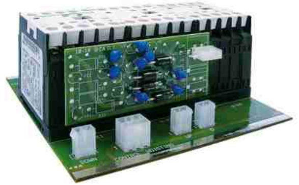
Birbirinden ayrı panellere monteli modüler kontaktörler Modular contactors mounted to individual boards
